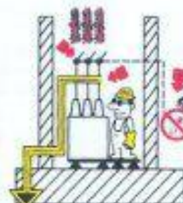
4. Poner a tierra y en cortocircuito.
